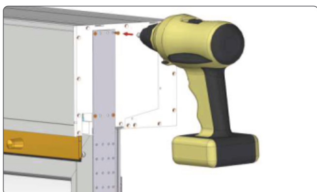
11. Önálló ablakoknál az univerzális tokrögzítő lemez alkalmazható. Rögzítése azonos.
