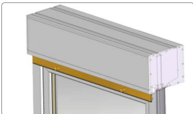
6. Helyezze és pattintsa rá az előkészített tokot a rápattintható adapterrel szerelt ablakkeretre.
