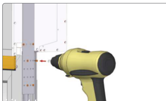
11. Önálló ablakoknál az univerzális tokrögzítő lemez alkalmazható. Rögzítése azonos.
