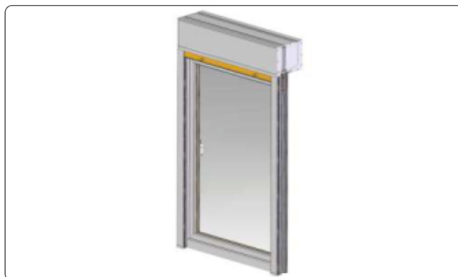
14. Az előbbieken alapján egyesített ablakkeretet és redőnyt készítse elő a beszerelésre.
