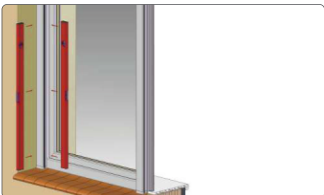
18. A végső falí rögzítés előtt ellenőrizze a vízszinteséget és a függőlegességet.
